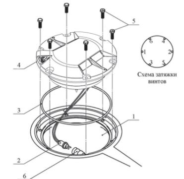
Рис. 2. Установка огня углубленного в основание
